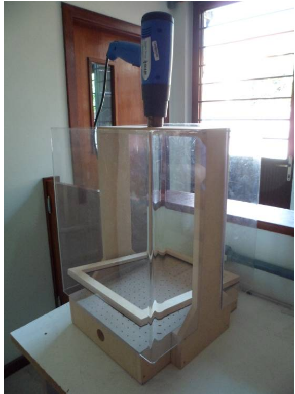
FIGURA 13: TERMOMODELADORA DE BAIXO CUSTO
