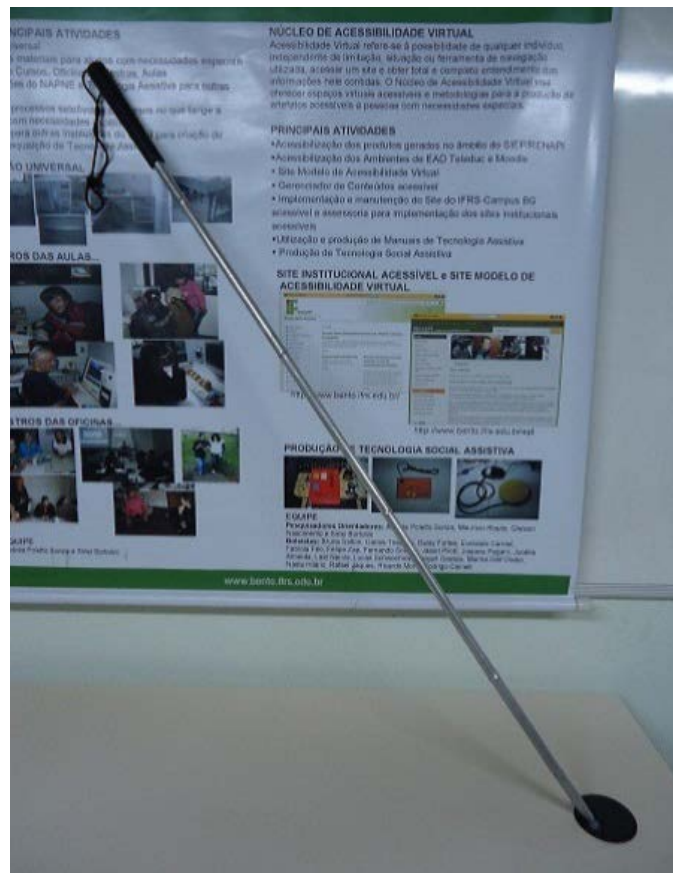
FIGURA 16: PONTEIRA DE BENAGALA QUE IDENTIFICA POÇAS DE ÁGUA
