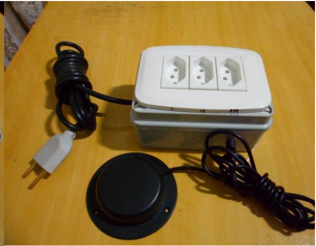
FIGURA 19: CENTRAL COM ACIONADOR DE PRESSÃO CONECTADO
