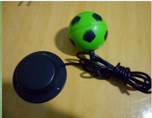
FIGURA 21: ACIONADOR DE PRESSÃO CONECTADO NA BOLINHA PERMITINDO QUE FUNCIONE SEM FIO
