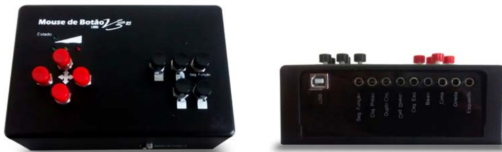
FIGURA 9: VISÃO FRONTAL (CONTENDO OS BOTÕES) E LATERAL (CONTENDO ENTRADAS USB E PARA ACIONADORES) DO MOUSE DE BOTÃO VERSÃO 3.25
