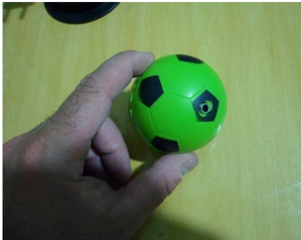
FIGURA 20: FOTO DA BOLINHA COM CONEXÃO PARA ACIONADOR EXTERNO
